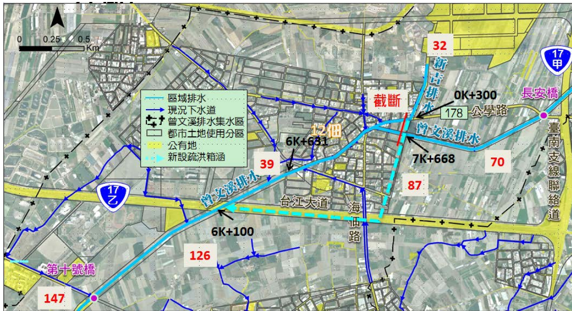
圖 5.2 新設疏洪箱涵流量分配及佈置圖
