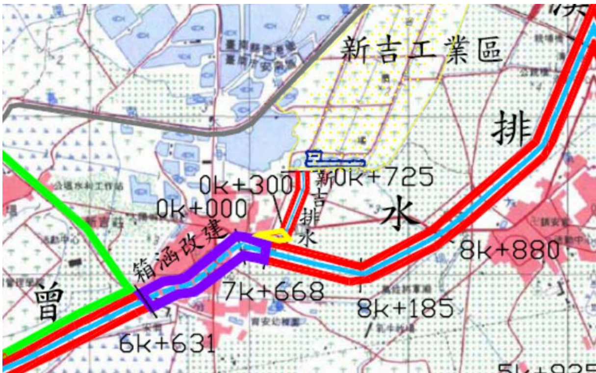
圖 4.1 曾文溪排水十二個段箱涵改善工程平面圖
