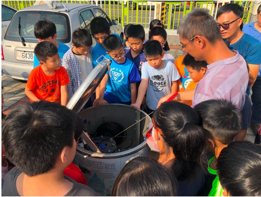
水利署第六河川局工程師現場解說地下水觀測站如何量測水深
